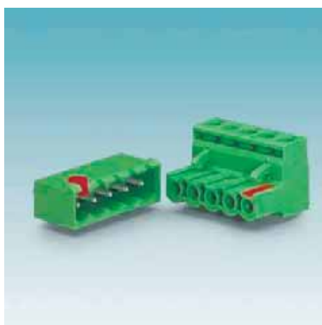
Пример разъемов, которые не допускают соединения
