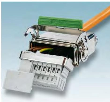
Перемычка звезда-треугольник расположена в сальниковом корпусе разъема для подключения электродвигателя. Для смены расположения перемычек клеммной панели в случае необходимости изменения схемы подключения корпус двигателя открывать не требуется. Теперь нужно просто откинуть сальник и повернуть звездообразную треугольную перемычку! Новая схема подключения готова.
