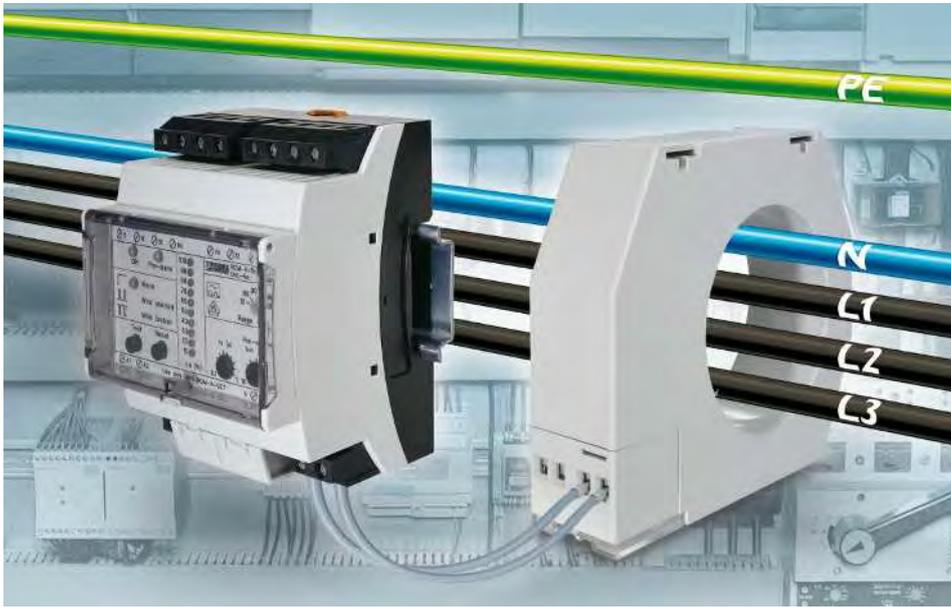
Устройства контроля разностного тока служат для контроля разностного тока в заземленных системах электропитания. Они своевременно распознают ток утечки, возникающий, например, при повреждении изоляции. Тем самым они позволяют предотвратить принудительное отключение. Неисправность можно устранить в плановом режиме по завершении эксплуатации. Кроме того, устройства контроля разностного тока позволяют предотвратить возникновение пожара.
