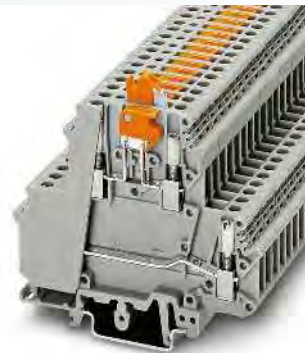
4 (4) мм 2 , 12 А, двухъярусная клемма с ножевым размыкателем винты с тестовым гнездом
