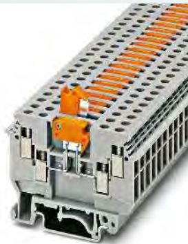
4 (6) мм 2 , 16 А, клемма с ножевым размыкателем, 4 подключения, винты с тестовым гнездом
