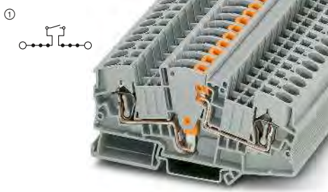
30 А, Клемма для измерит. трансформаторов
