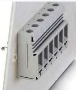
Проходные клеммы, герметизируемые заливкой, внутренняя часть с выводами под пайку и гайкой с накаткой
