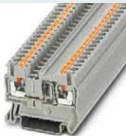
0,5 А, диодная клемма, 1N 4007 (1300 В/0,5 А)
