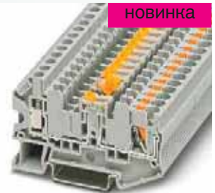
20 А, клемма с размыкателем, 3 функциональных отверстия и два контрольных гнезда 4 мм
