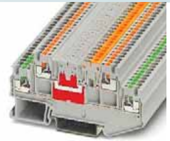
9 А, двухъярусная клемма с ножевым размыкателем на верхнем ярусе
