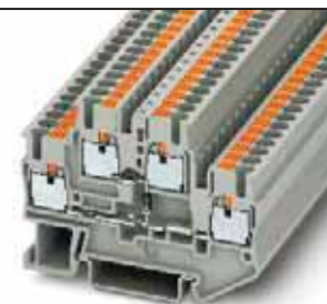
26 А, диодные двухъярусные клеммы, 1N 4007 (1300 В/0,5 А)
