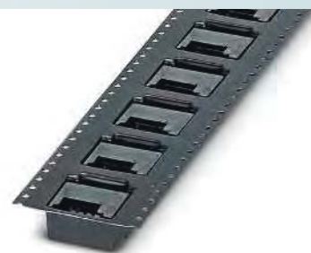
1-рядн., в ленте, для SMD-монтажа, подключение параллельно печатной плате
