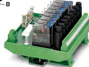
Модуль вывода с 8 мини-реле, 1 переключающий контакт с возможностью ручного управления и предохранитель на каждой выходной цепи
