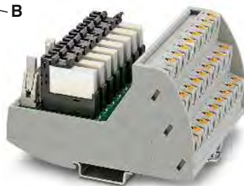
Модуль цифрового ввода с 8 каналами для 24 В пост. тона
