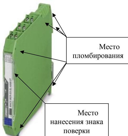
Рисунок 1 - Общий вид, схема пломбировки от несанкционированного доступа и обозначение места нанесения знака поверки
