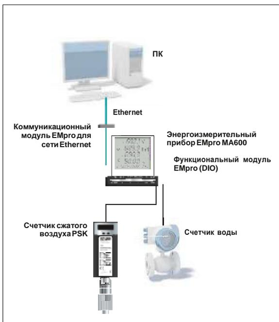
Возможность привязки до шести внешних счетчиков к одному EMpro MA600
