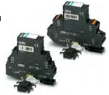
Защита 3 проводников для полевой шины и последовательного интерфейса, соединение 9/10 заземлено напрямую
