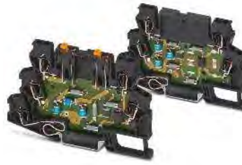
Двойная жила, без потенциала земли, например, для токовой петли 4 ... 20 мА
