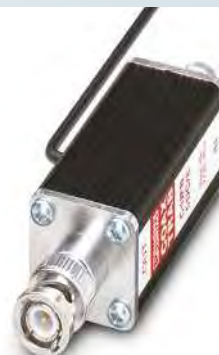
Для видеосистем, экран без потенциала земли, подключение: BNC
